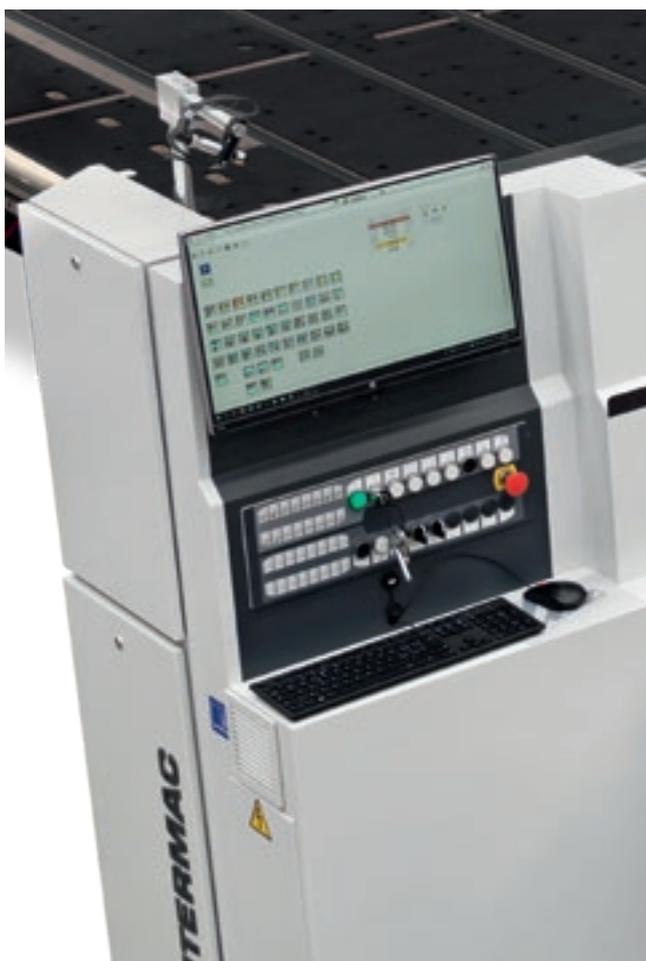
A interface do operador é simples e intuitiva e permite importar programas de corte gerados pelos aperfeiçoadores presentes no mercado, graças à integração da interface universal OTD (Optimiser Transferring Data), que define de forma automática os parâmetros de corte e gera automaticamente o programa para a mesa de corte.
