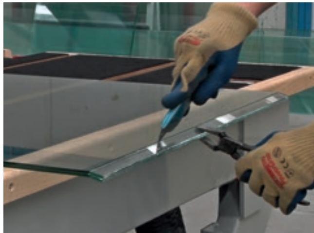
Corte + troncamento automático + destaque manual 20 mm.
